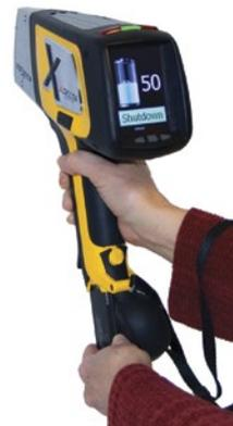
Con la stazione di alloggiamento DELTA di concezione unica non è necessario spegnere lo strumento. La stazione ricarica la batteria dell'analizzatore e quella di ricambio oltre a eseguire periodiche verifiche di taratura. Il DELTA può funzionare ininterrottamente sul campo mediante batterie sostitutive di tipo hot swap.
