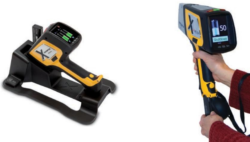
Con la stazione di alloggiamento DELTA di concezione unica non è necessario spegnere lo strumento. La stazione ricarica la batteria dell'analizzatore e quella di ricambio oltre a eseguire periodiche verifiche di taratura. L'analizzatore DELTA può funzionare ininterrottamente sul campo mediante batterie sostitutive di tipo hot swap.
