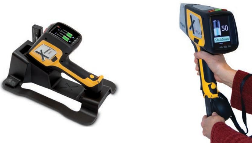
Estação de acoplamento DELTA exclusiva que evita a necessidade de desligar o analisador. A estação carrega a bateria do analisador, a bateria sobressalente e realiza verificações periódicas da calibração. Os analisadores DELTA podem ser operados sem interrupção 24 horas por dia 7 dias por semana devido ao modo de substituição de baterias *hot swap*.
