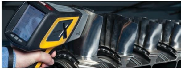
L'analyseur DELTA peut comparer les résultats aux compositions chimiques de la bibliothèque des alliages afin d'établir l'équivalence entre un élément inconnu et un alliage existant. Il est possible de préprogrammer des messages contextuels contenant des instructions de tri ou de codage en temps réel pour accroître la cadence et l'efficacité des analyses.
