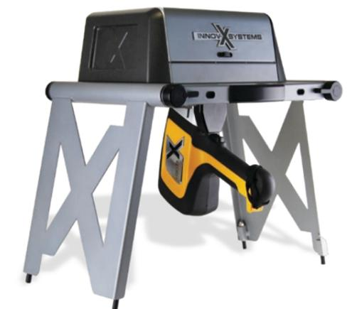
Le poste d'analyse portable DELTA est équipé d'un blindage avec verrouillage de sécurité et peut être contrôlé à l'aide d'un PC.
