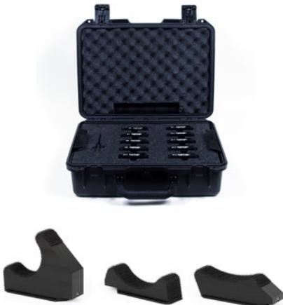
Der Prüfsatz für Rohre enthält 15 Vorlaufkeile für Rohre mit einem Durchmesser von 33,4 mm und größer.
