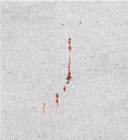
红色渗透剂表明的缺陷指示
