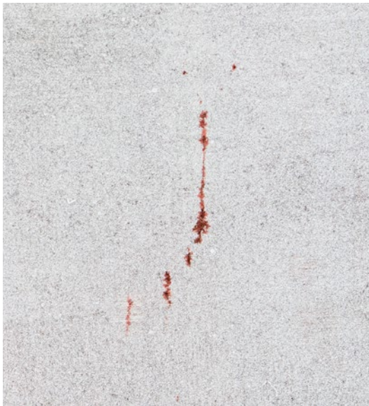
红色渗透剂表明的缺陷指示
