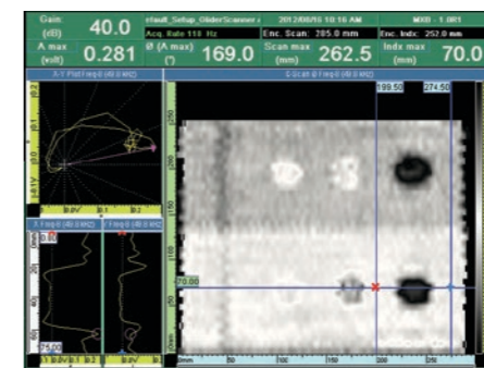
Balayage de haute fréquence : C-scan de phase, palette de couleurs distincte
