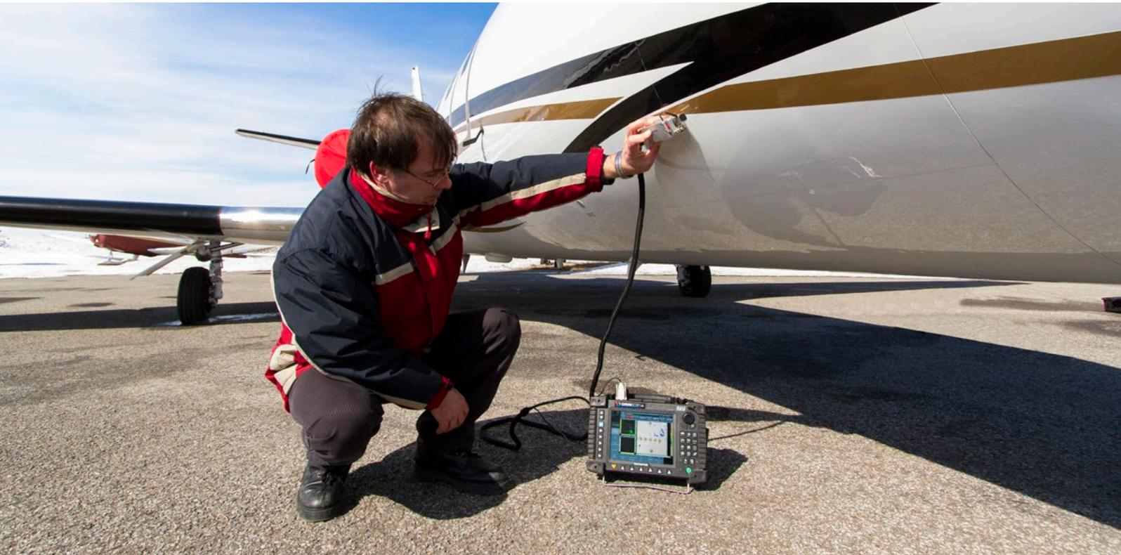
Partout dans le monde, les aéronefs sont constamment soumis à de drastiques changements de température créant de la condensation et de l'humidité sous le revêtement d'aluminium des appareils. L'environnement humide qui se crée entre les couches du revêtement entraîne de la corrosion qui doit absolument être détectée au cours des inspections en service et ensuite réparée.
