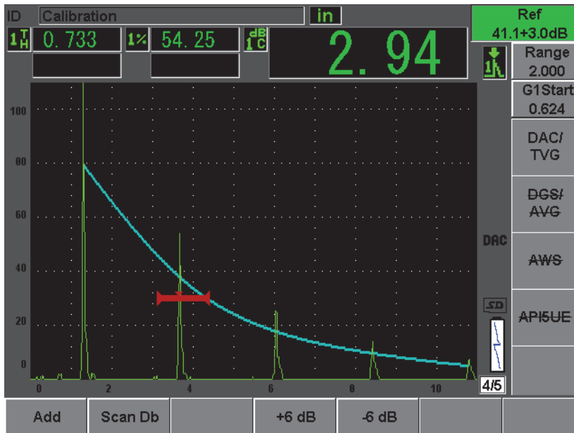
Abbildung 12-9 ASME-DAC mit 3 dB Prüfverstärkung
