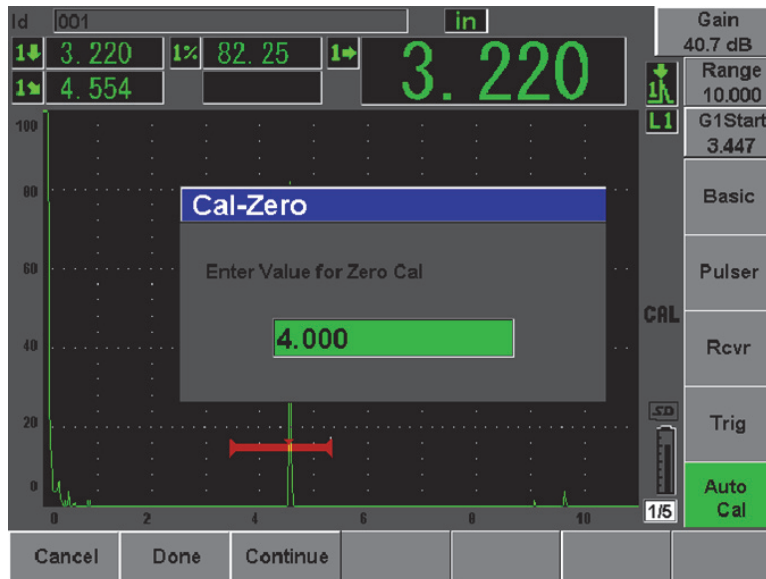
Abbildung 10-21 Eingabe der Dicke für die Nullpunktjustierung
