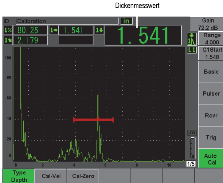
Abbildung 10-26 Signal in der Blende bei der Nullpunktjustierung (Beispiel)
