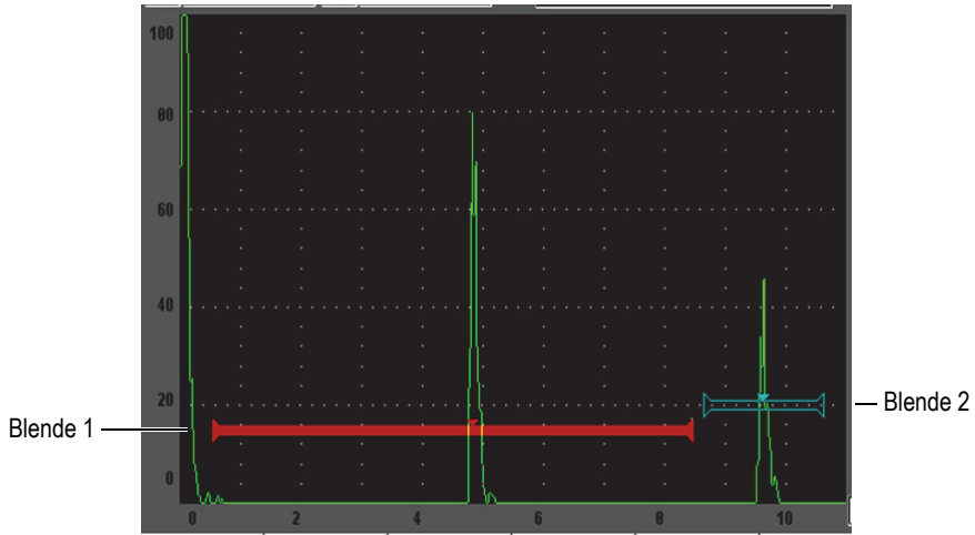
Abbildung 5-11 Beispiel eines A-Bilds mit Blenden
