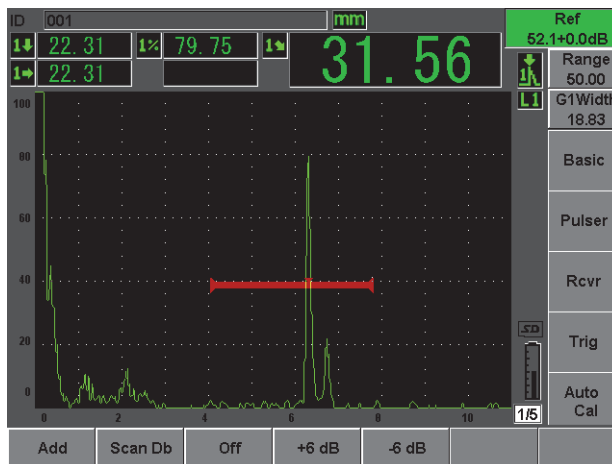
Abbildung 2-18 Einstellen der Referenzverstärkung
