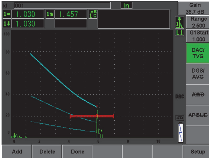
Abbildung 12-4 DAC-Einrichtung mit einem Punkt
