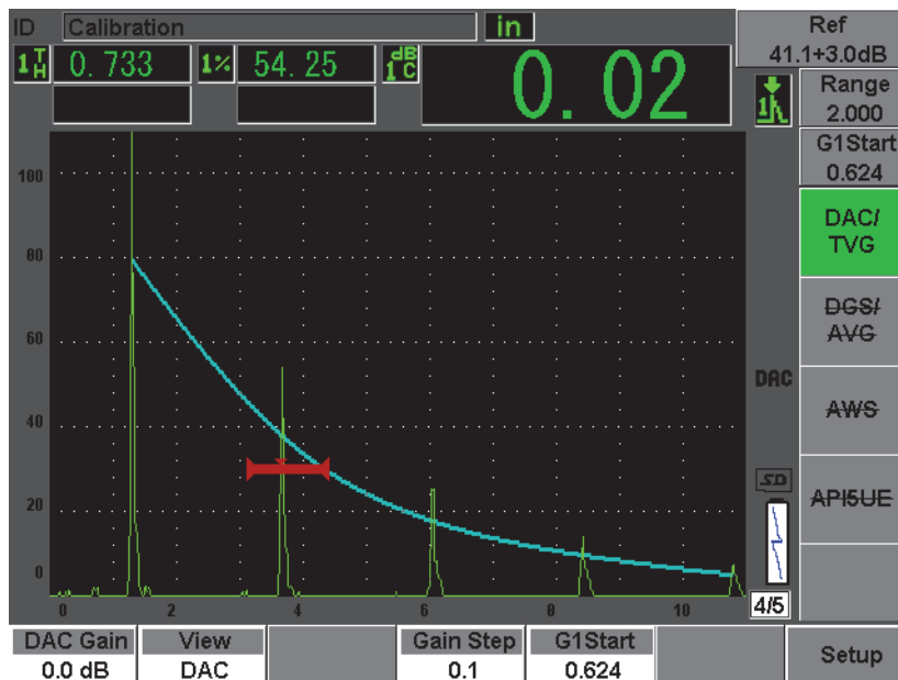
Abbildung 12-10 ASME DAC mit 3 dB Prüfverstärkung und aktivierter Referenzkorrektur
