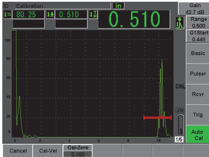
Abbildung 10-8 Signal in der Blende für die Justierung der Schallgeschwindigkeit (Beispiel)
