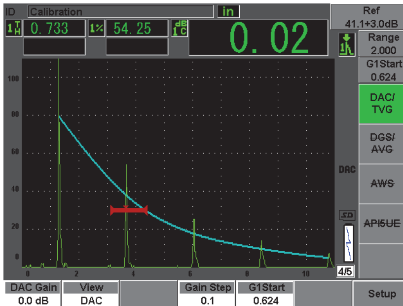
Figure 12-10 Courbe DAC de type ASME avec ajout d'un gain de balayage de 3 dB et correction de référence activée
