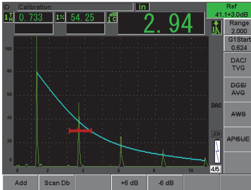
Figure 12-9 Courbe DAC de type ASME avec ajout d'un gain de balayage de 3 dB
