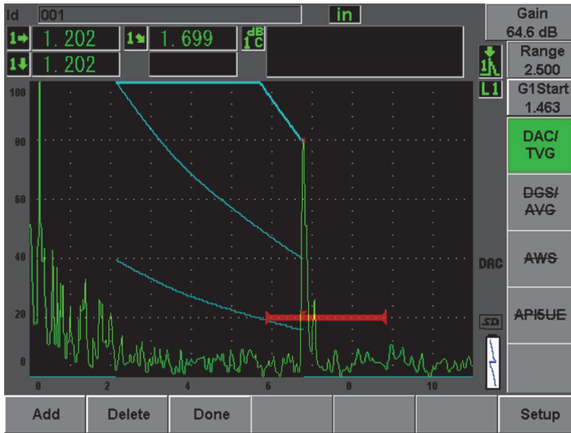
Figure 12-5 Courbe DAC partielle avec tous les échos à 80 % de la hauteur plein écran
