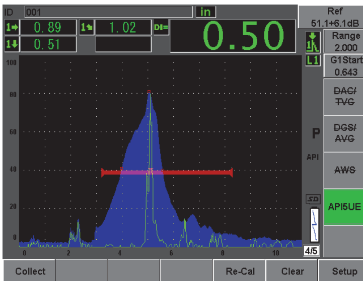
Figura 12-21 Dimensionamento API 5UE completato
