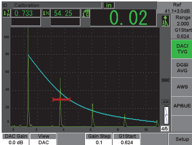
Figura 12-10 Curva DAC di tipo ASME con l'aggiunta di un guadagno di scansione di 3 dB e la correzione di riferimento attivata
