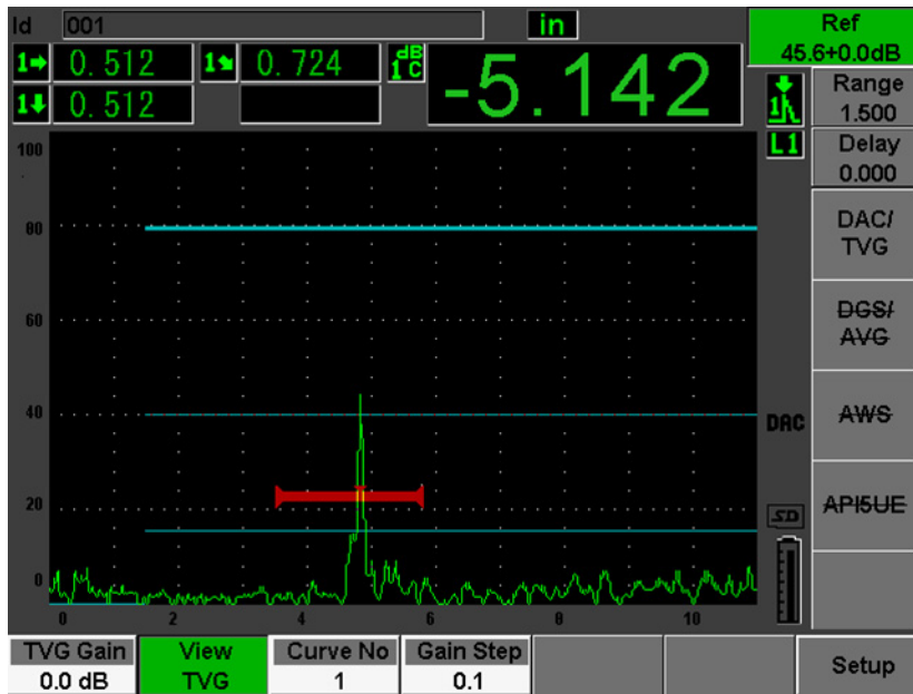
図 12-7 DAC ビューモードでの完成した DAC 曲線
