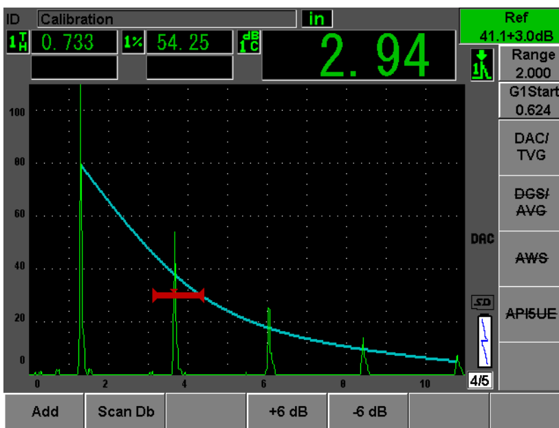
図 12-9 補正ゲイン 3 dB を追加した ASME DAC
