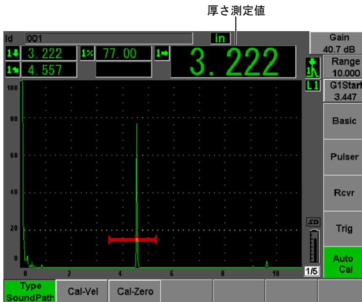
図 10-20 ゼロ校正のためのゲート設定された信号の例
