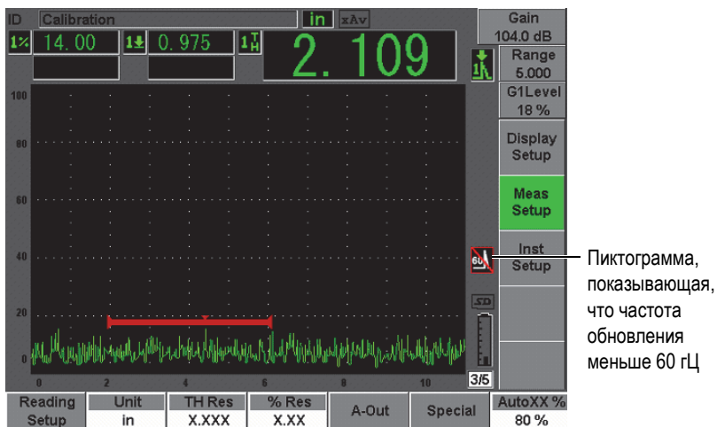
Рис. 12-30 Частота обновления изображения меньше 60 гЦ
