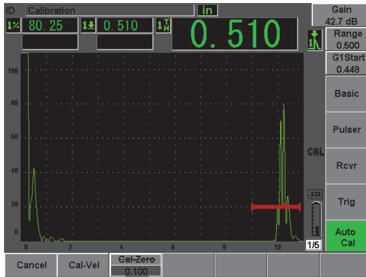
Рис. 10-8 Пример стробированного сигнала для калибровки скорости
