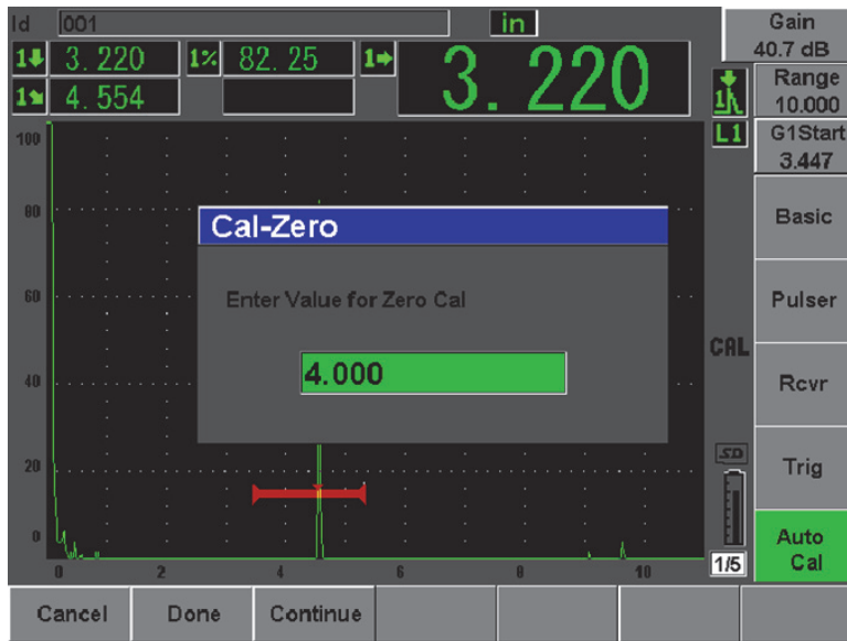
Рис. 10-21 Введение значения толщины для калибровки нуля
