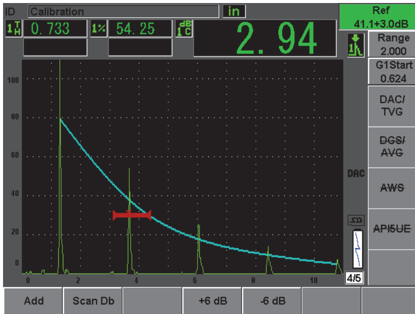
Рис. 12-9 ASME DAC с добавленным усилением 3дБ
