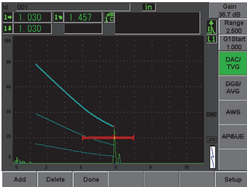
Рис. 12-4 Настройка DAC: первая точка
