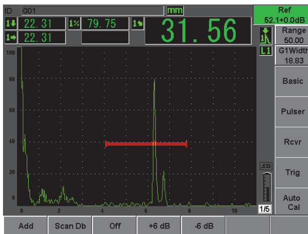
Rysunek 2-18 Ustawienia referencyjnego dB (gain)
