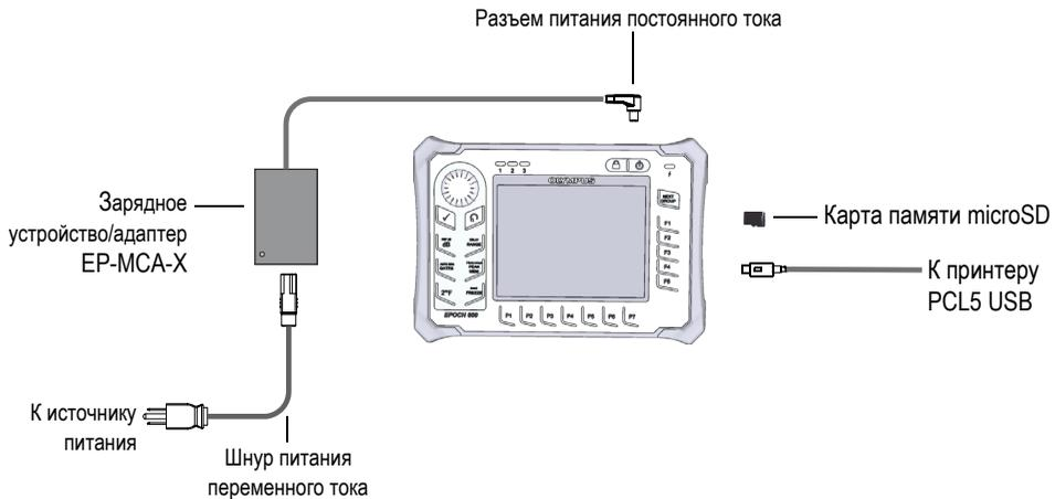
Рис. 1-2 Подключения прибора ЕРОСН 600/ЕРОСН 650
