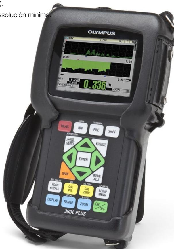
Medidor de espesores 38DL PLUS
