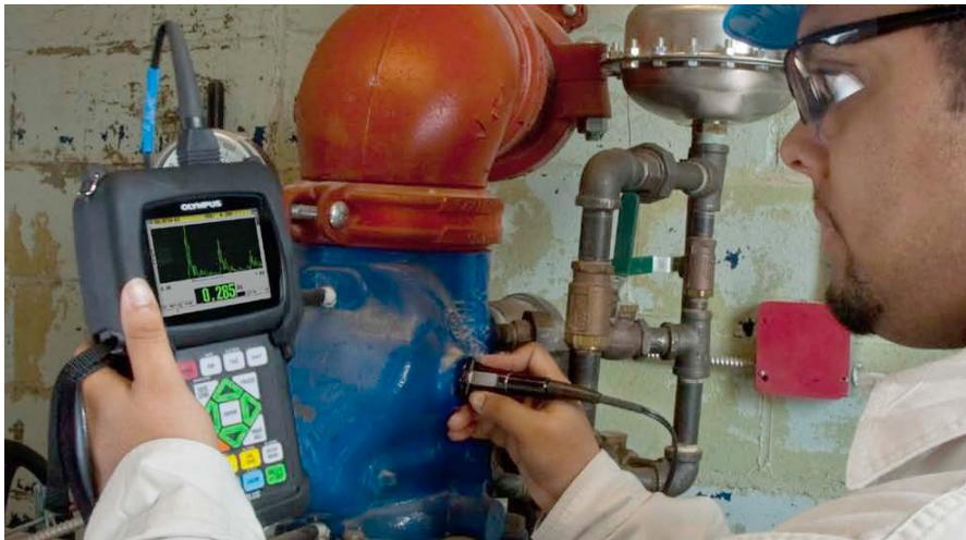
图 1-1 使用 38DL PLUS 仪器测量材料的厚度
