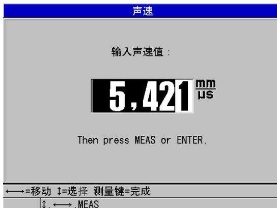
图 5-7 输入一个已知材料声速
