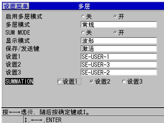
图 7-7 在常规模式下设置多层测量参数
