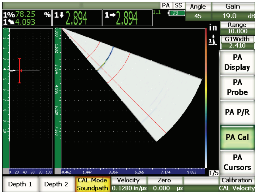
Obr. 17-13 Kalibrační signál uzavřený branou
