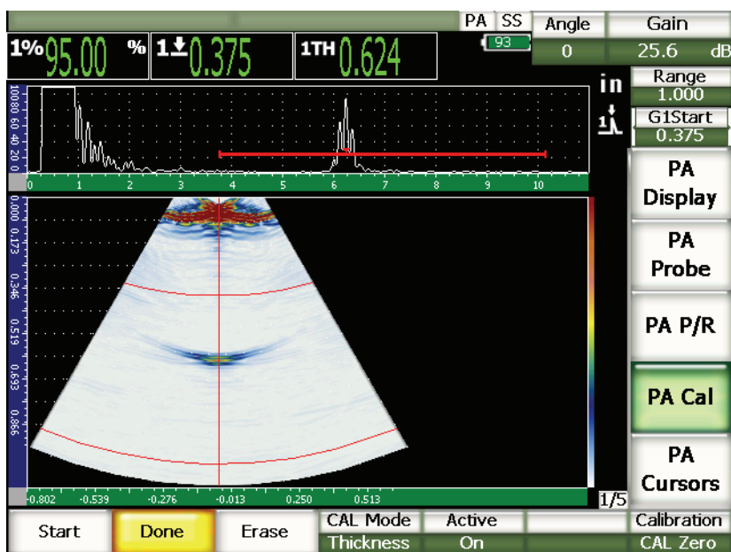
Obr. 17-8 Dokončená kalibrace zpoždění předsádky
