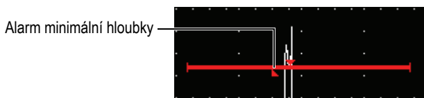
Obr. 6-8 Alarm minimální hloubky
