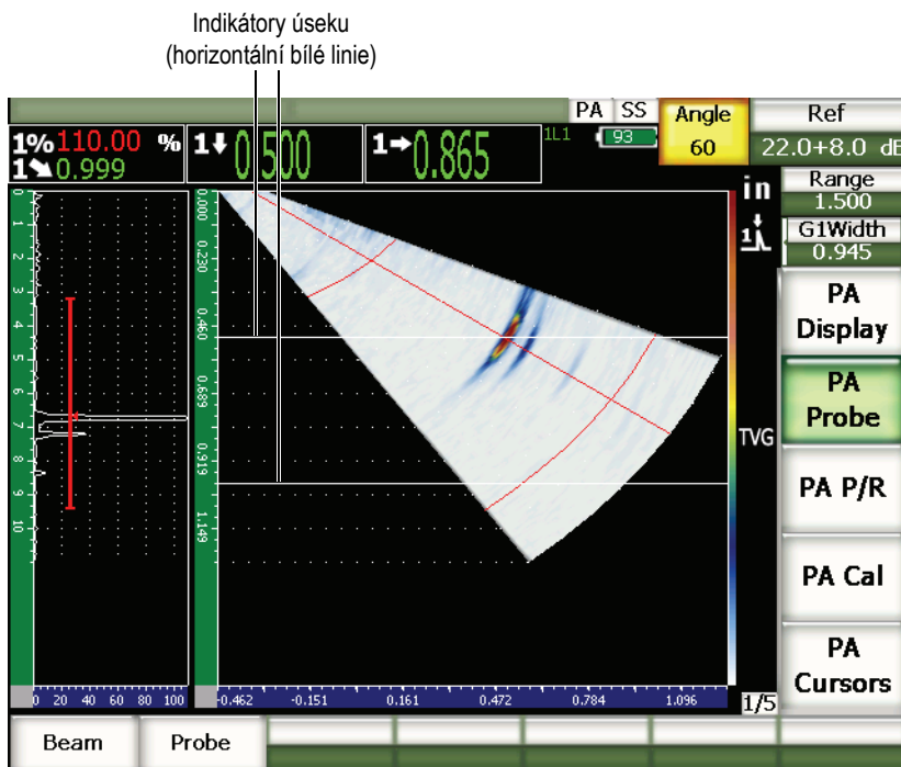
Obr. 14-9 S-zobrazení s aktivními indikátory úseku
