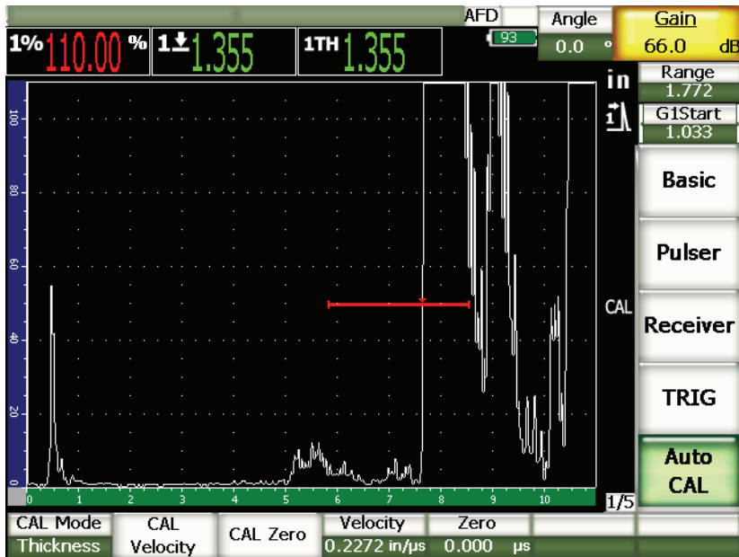
Obr. 9-9 Druhý kalibrační signál uvnitř brány
