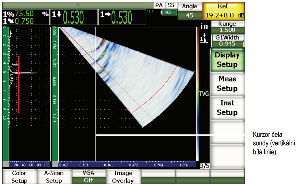
Obr. 14-8 S-zobrazení s aktivním kurzorem čela sondy
