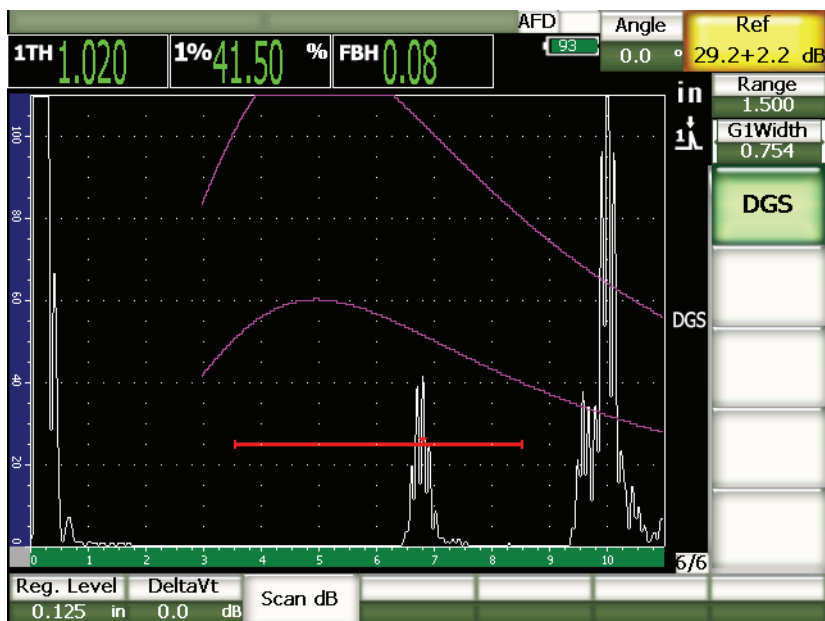
Obr. 11-22 DGS se zesílením křivky
