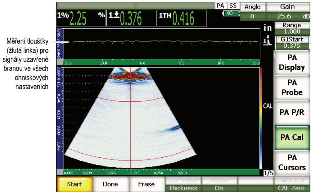
Obr. 17-7 Obrazovka zachycující zpoždění předsádky, s odečtem měření tloušťky v horní části
