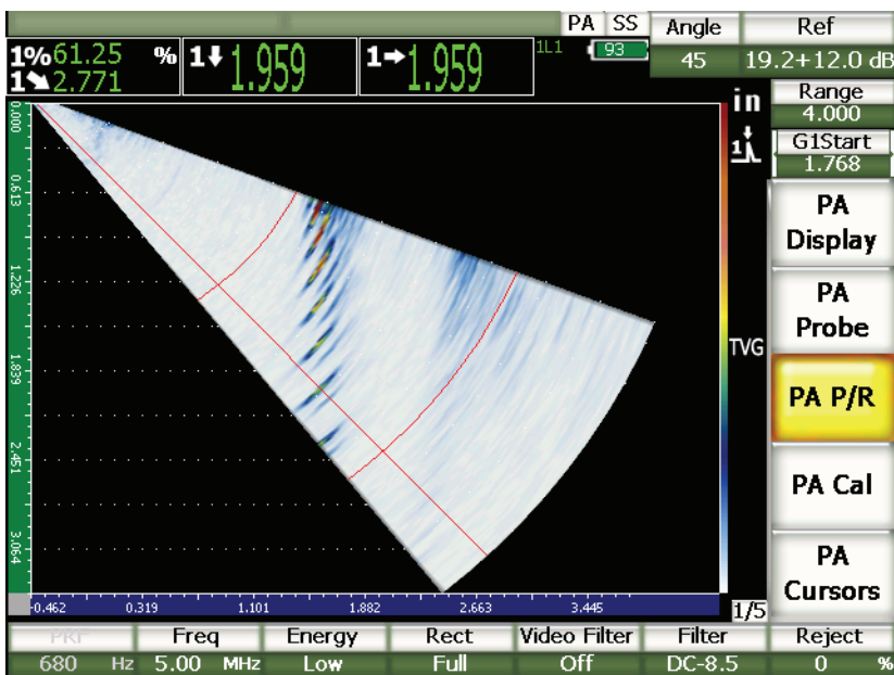
Obr. 12-2 S-zobrazení 40°–70° s čtyřpalcovou zvukovou dráhou
