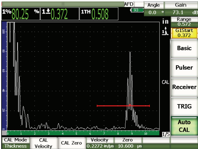
Obr. 9-6 Druhý kalibrační signál uvnitř brány
