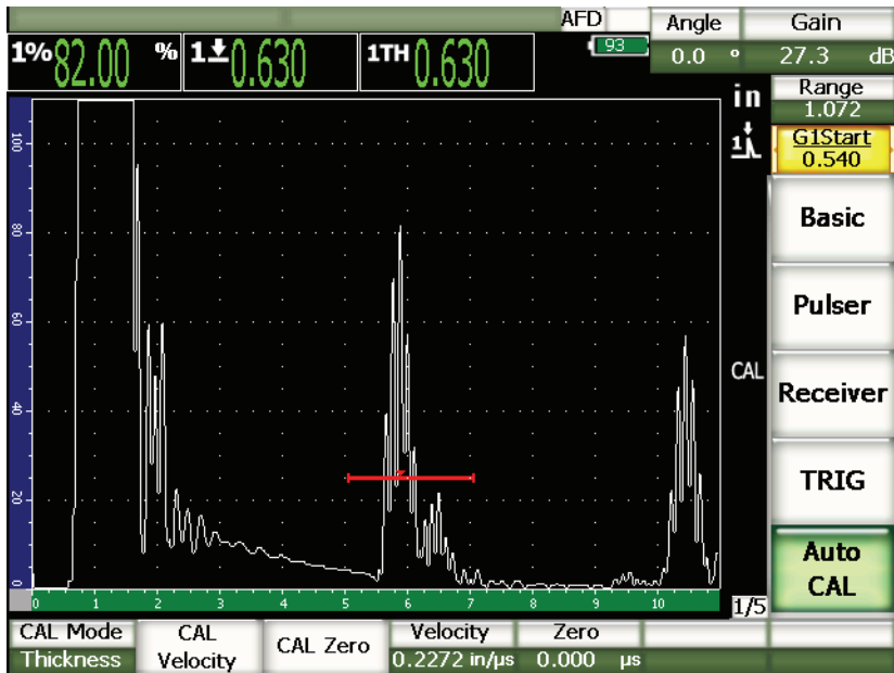
Obr. 9-3 Druhý kalibrační signál uvnitř brány
