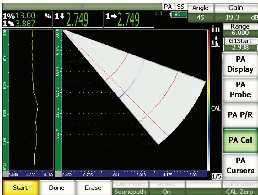
Obr. 17-20 Obrazovka se záznamem zpoždění předsádky
