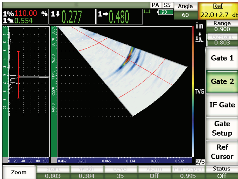
Obr. 15-1 A-zobrazení a S-zobrazení se znázorněnými branami a označením
