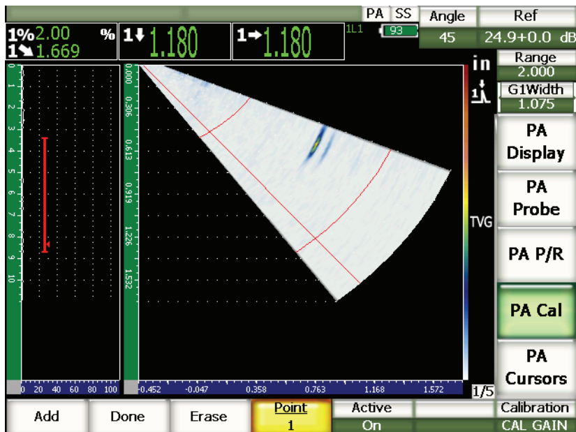
Obr. 17-24 Dokončená kalibrace zesílení
