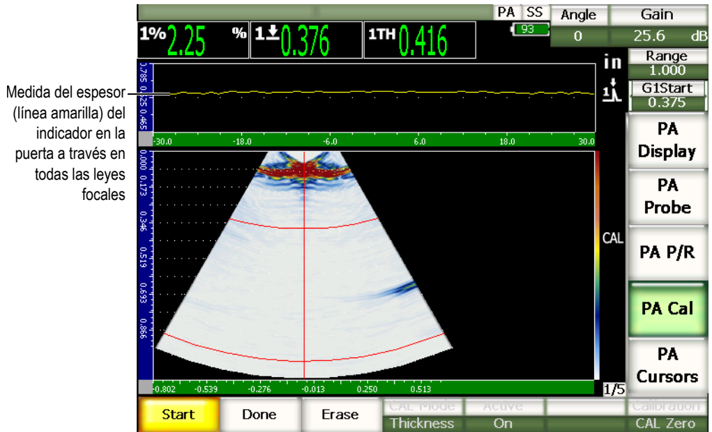
Figura 17-7 Lectura de la medición del espesor en la parte superior de la pantalla de adquisición del retardo de la zapata
