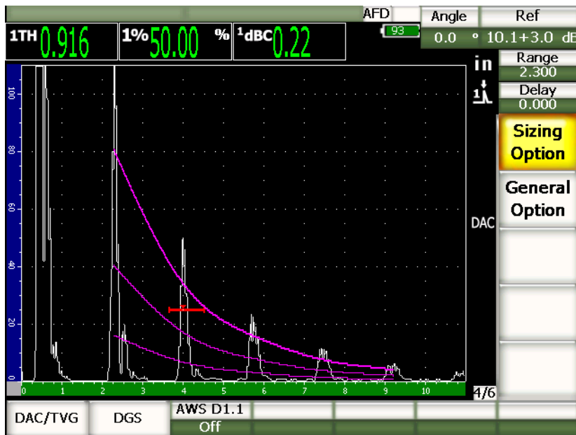
Figura 11-11 Curva DAC de tipo ASME con la ganancia de inspección añadida de 3 dB y la corrección de referencia activada
