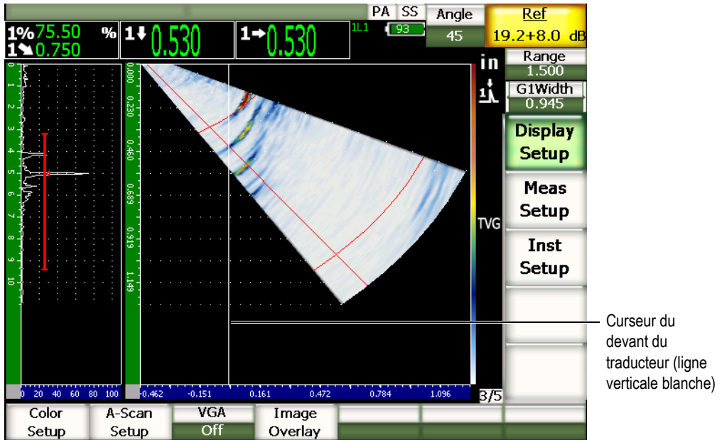
Figure 14-8 S-scan avec curseur du devant du traducteur activé
