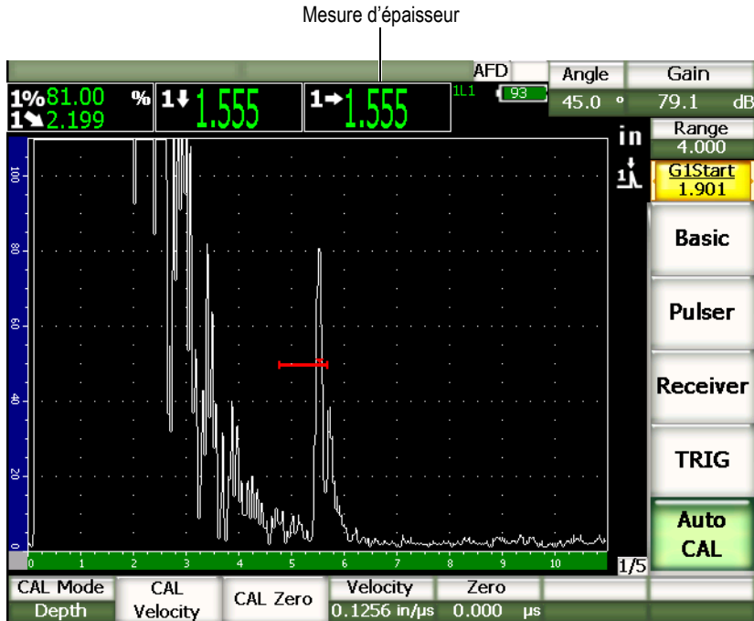
Figure 9-21 Exemple d'un signal d'étalonnage dans une porte
