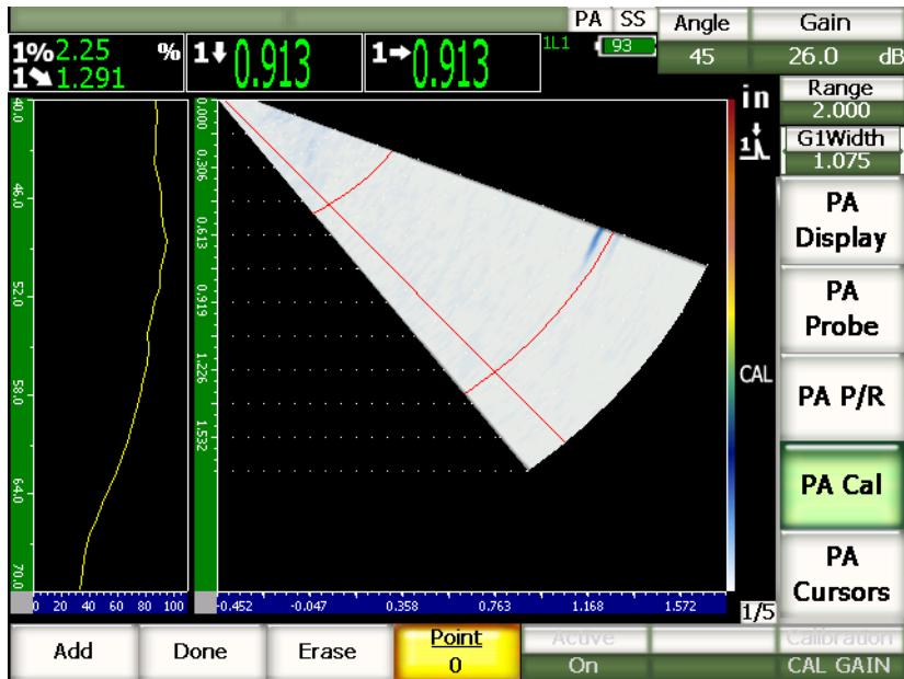
Figure 17-23 Écran d'acquisition du gain
