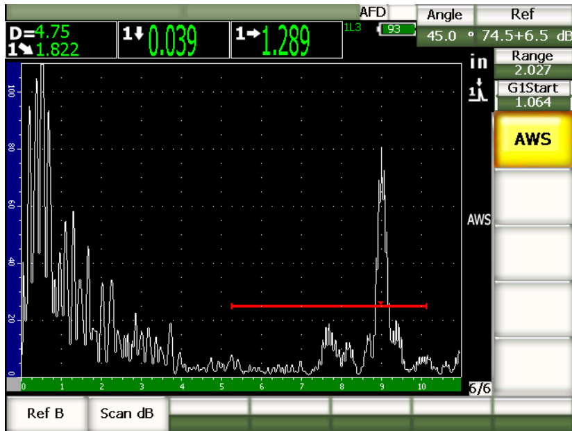
Figure 11-24 Vue AWS activée avec valeur de classification D
