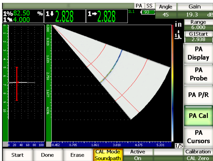
Figure 17-21 Étalonnage du délai du sabot complété
