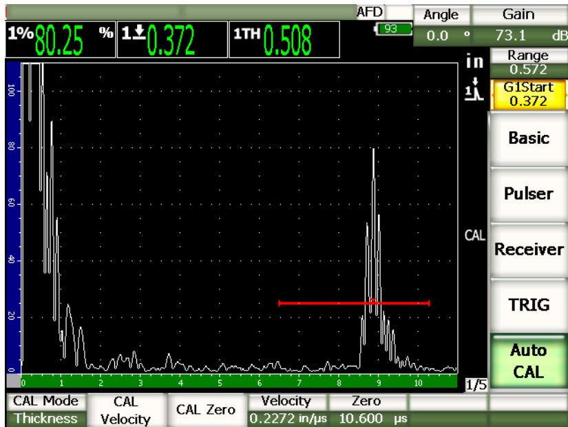
Figure 9-6 Second signal d'étalonnage dans la porte
