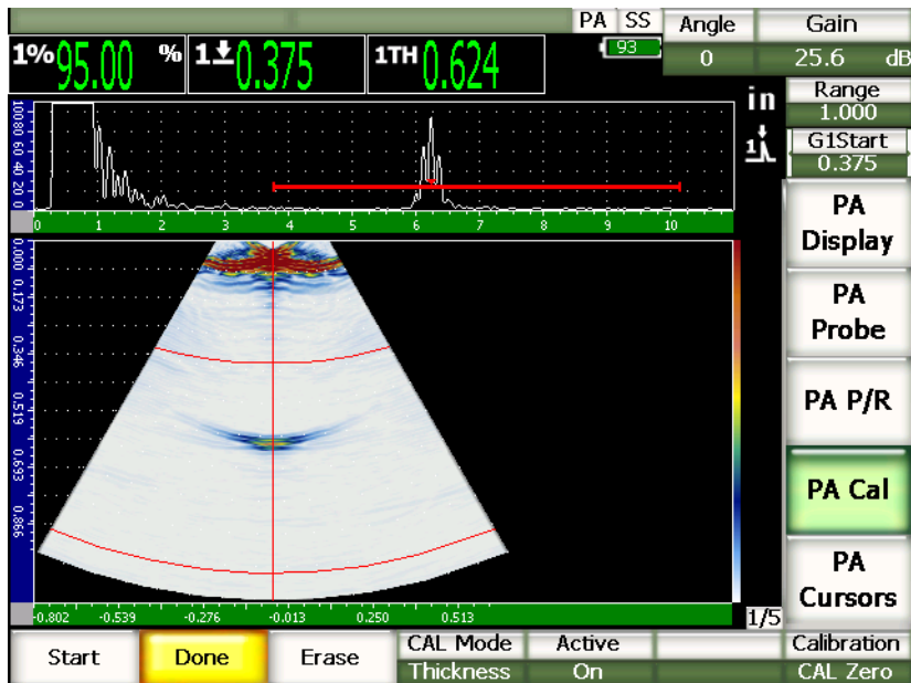
Figure 17-8 Étalonnage du délai du sabot complété
