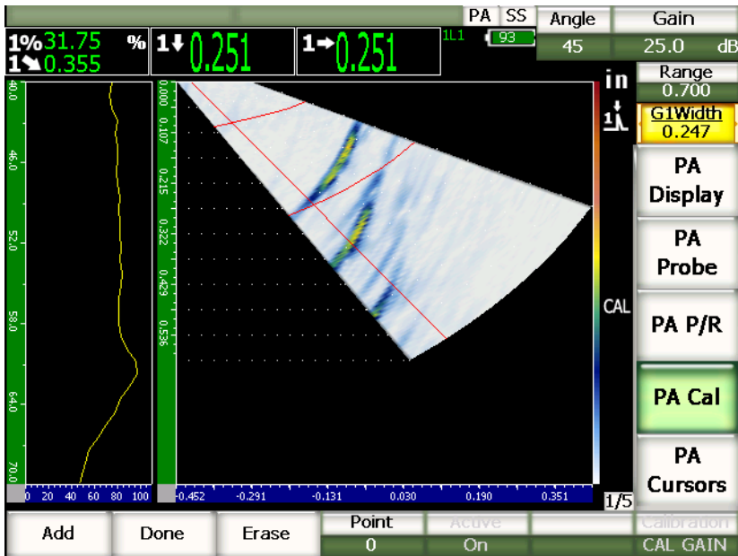
Figure 17-26 Porte étroite pour la capture d'un seul écho.
