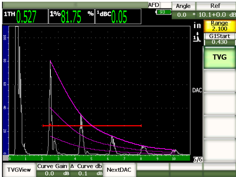
Figure 11-7 Courbe DAC complétée
