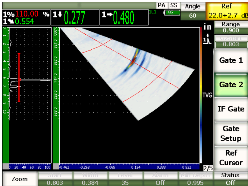
Figure 15-1 Vues A-scan et S-scan avec affichage des portes et des marques.
