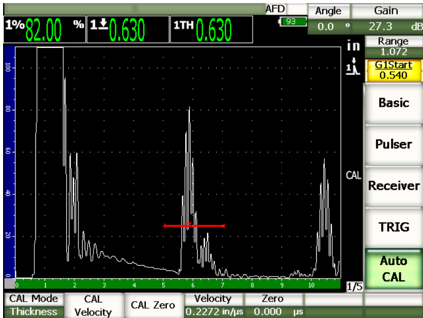
Figure 9-3 Second signal d'étalonnage dans la porte
