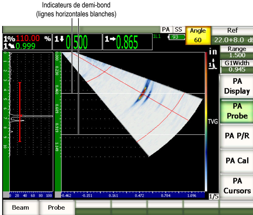
Figure 14-9 S-scan avec indicateurs de demi-bonds activés
