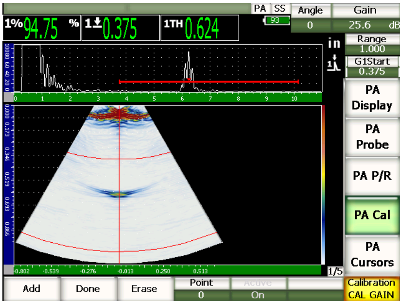
Figure 17-9 Exemple d'écho capturé
