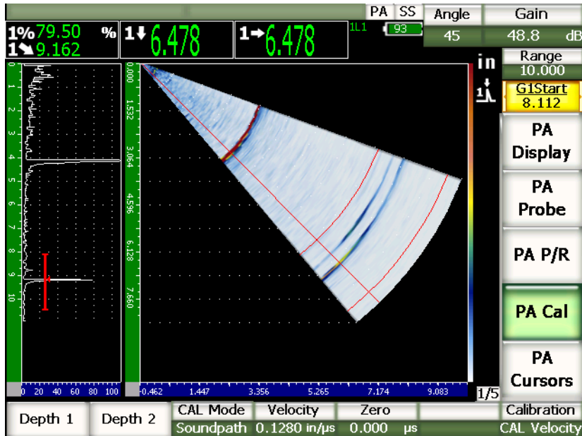
Figure 17-15 Second signal d'étalonnage dans la porte
