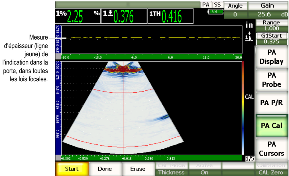
Figure 17-7 Écran d'acquisition du délai du sabot avec lecture de la mesure d'épaisseur affichée dans la partie supérieure.
