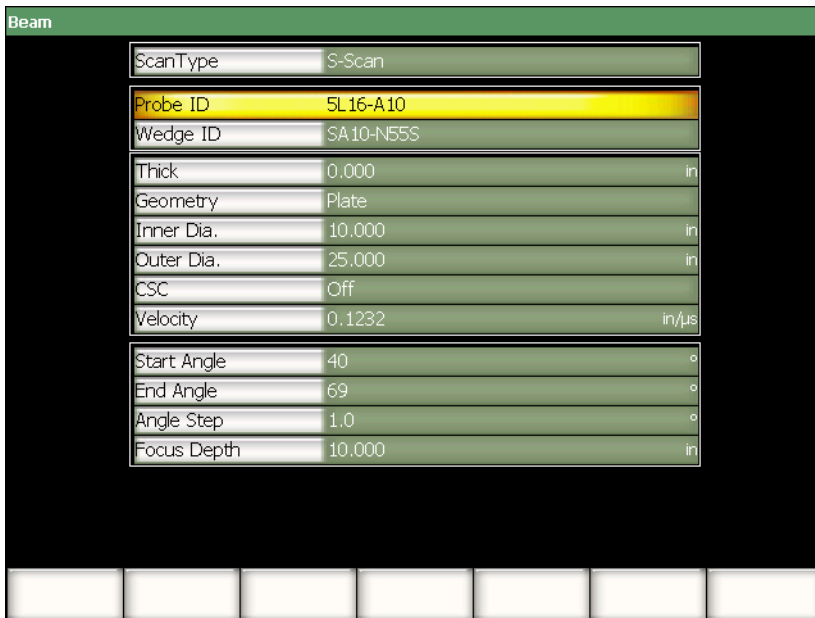
Figure 2-2 Page de configuration Faisceau s'affichant au démarrage lorsqu'un traducteur multiéléments est connecté à l'appareil
