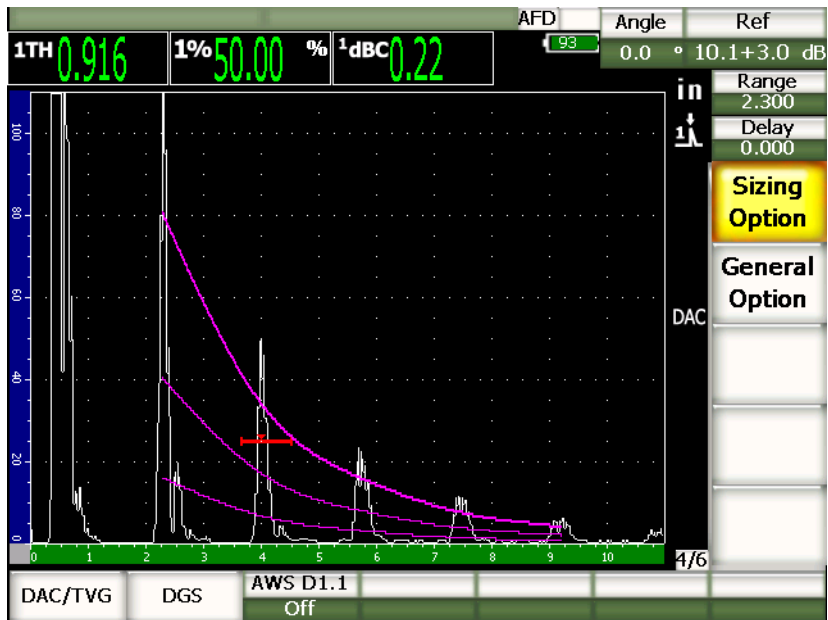
Figure 11-11 Courbe DAC de type ASME avec ajout d'un gain d'inspection de 3 dB et correction de référence activée
