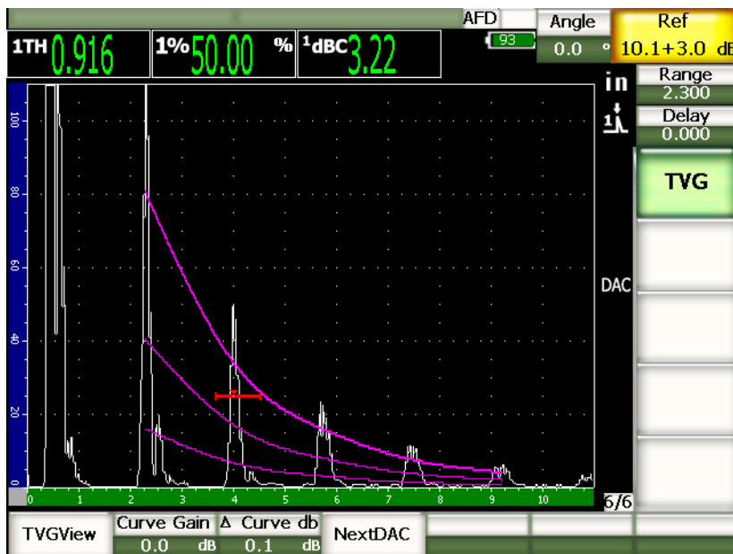
Figure 11-10 Courbe DAC de type ASME avec ajout d'un gain d'inspection de 3 dB
