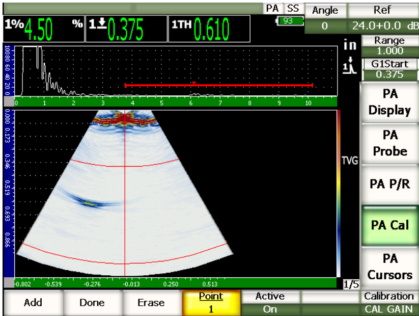
Figure 17-11 Pour terminer l'étalonnage du gain
