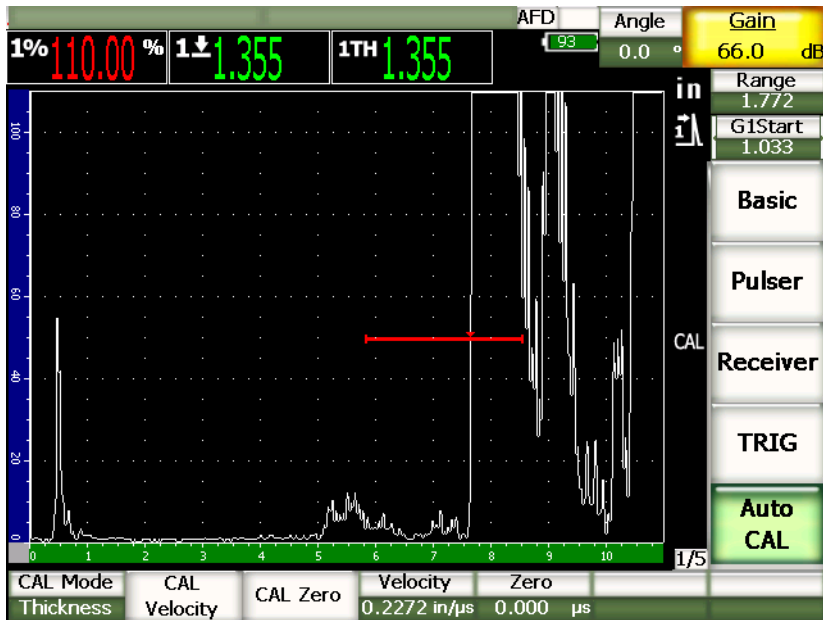
Figure 9-9 Second signal d'étalonnage dans la porte
