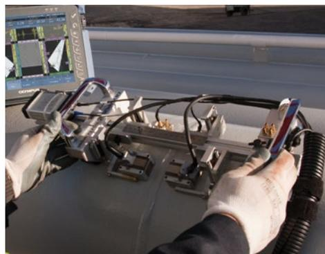
El escáner AxSEAM™ puede ser usado para inspeccionar soldaduras longitudinales en tuberías de acero al carbono con un diámetro externo igual o superior a 6 pulg.
