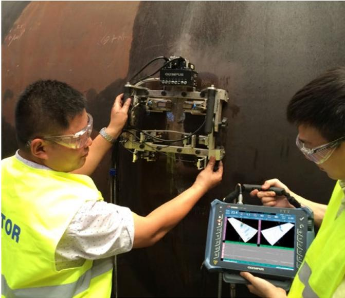
Nuestras soluciones versátiles para inspeccionar soldaduras utilizan una variedad de técnicas que permiten efectuar inspecciones productivas y eficientes en placas y tuberías con un diámetro externo superior a 4,5 pulg. Las técnicas por ultrasonido multielemento, difracción del tiempo de vuelo y ultrasonido convencional pueden ser utilizadas independientemente o en combinación para obtener una cobertura completa de la soldadura que favorece la alta probabilidad de detección.
