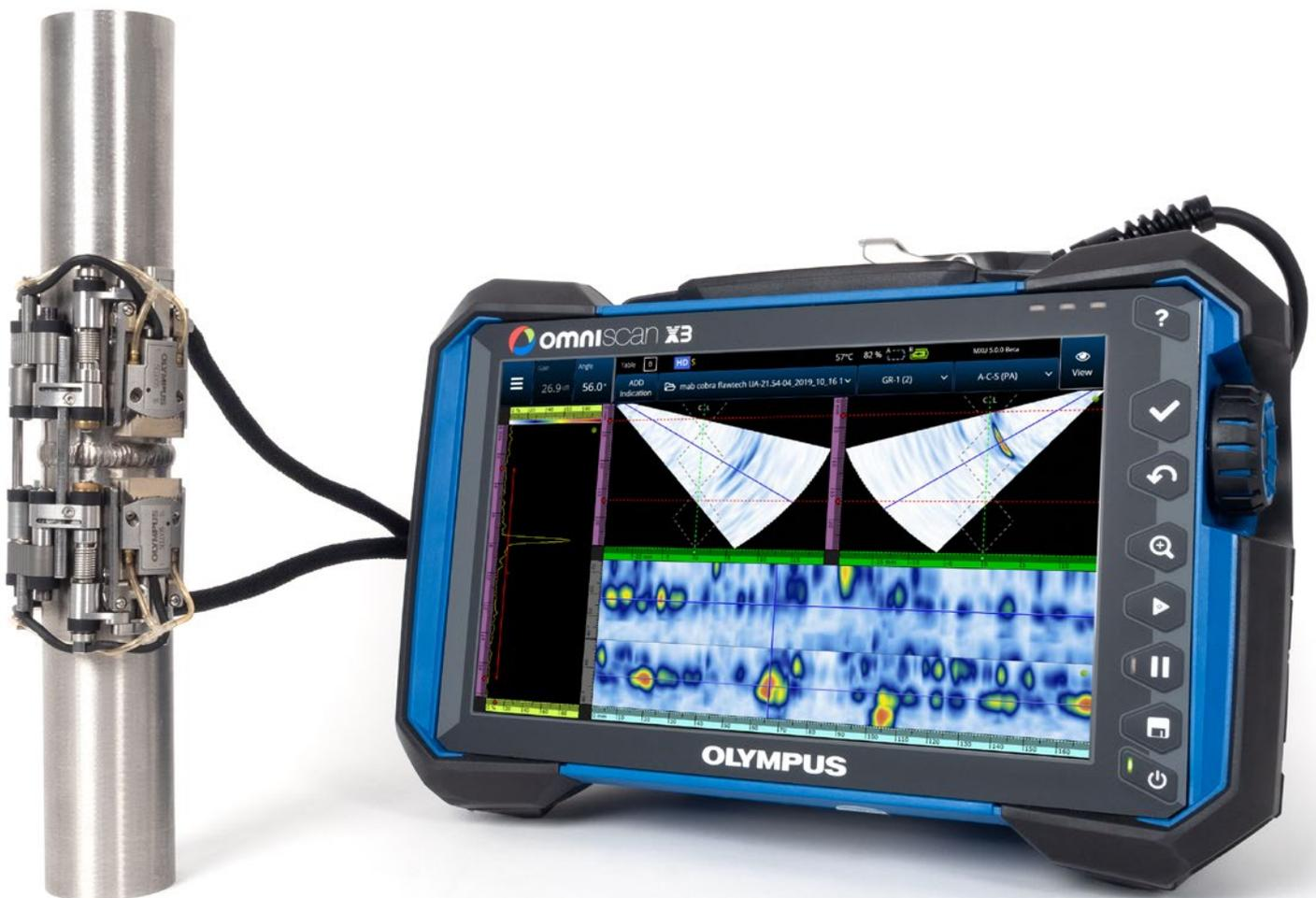
Escáner COBRA en una tubería de 0,84 pulg. de diámetro externo con dos sondas *Phased Array* A15 y un detector de defectos OmniScan® MX3 de 16:64 elementos, representando dos grupos de ultrasonido multielemento mediante escaneos sectoriales y C-scan.
