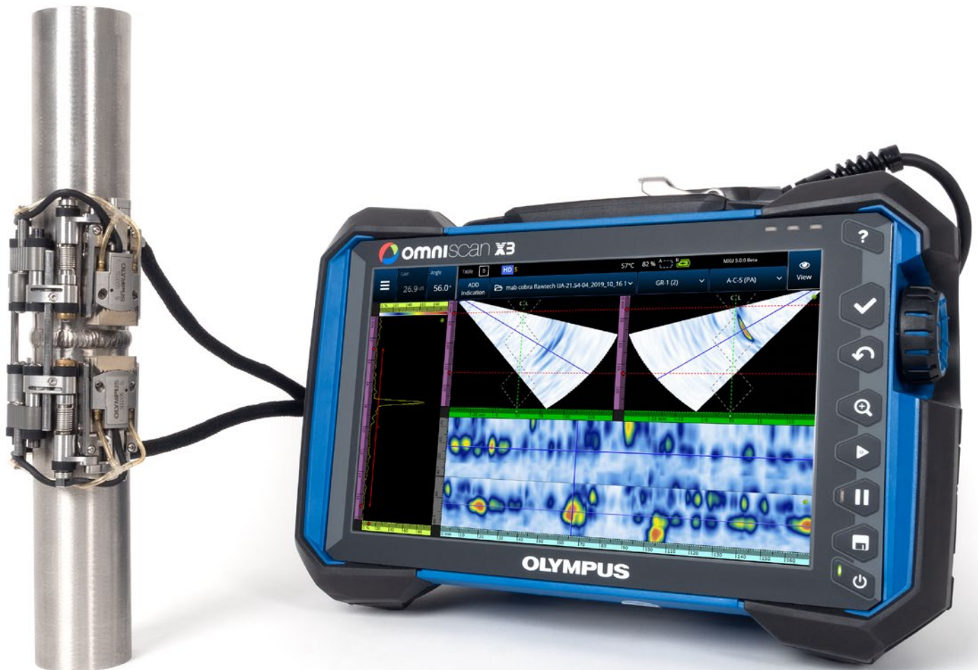
外径0.84インチのパイプ検査にCOBRAスキャナーを使用。2本のA15 PAプローブをOmniScan X3探傷器に装着。セクタースキャンとC-スキャンを2つのPAグループで表示。
