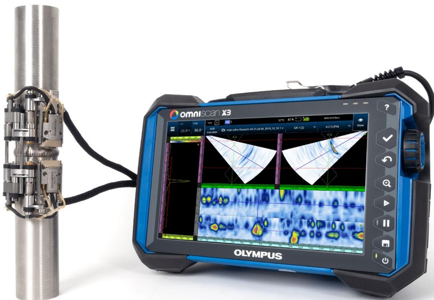
O escâner COBRA em um tubo com 0,84 pol. de diâmetro externo com duas sondas PA A15 com um detector de defeitos OmniScan X3 mostrando dois grupos PA com escaneamentos setoriais e C-scan.
