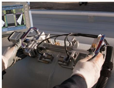
O escâner AxSEAM™ pode ser usado para inspeção de soldas longitudinais de tubos de aço carbono com diâmetro externo de 6 pol. ou mais.
