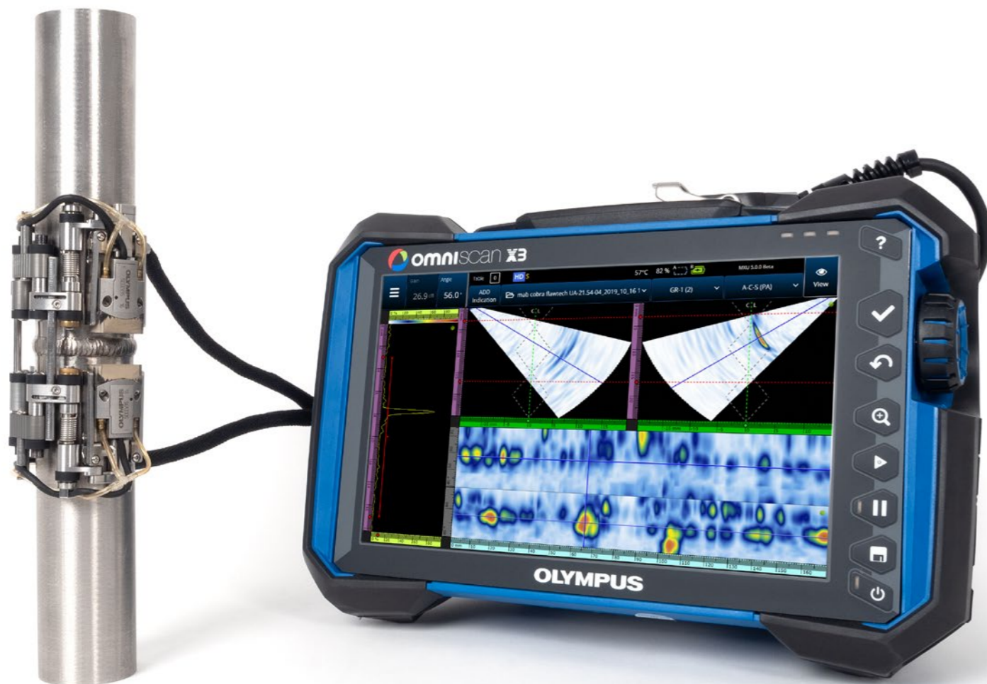
Сканер COBRA на трубе (диам. 21 мм) с двумя ФР-ПЭП А15 и дефектоскопом OmniScan X3. Экран OmniScan отображает две группы ФР (РА) с секторными сканами и С-сканами.
