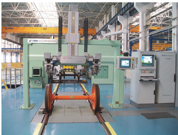
Figura 4 Ejemplo de un sistema completo de inspección automatizada 1
