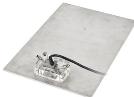
Seitlich ausgerichtete Sensoren und Vorlaufkeile für Phased-Array zur Erkennung von längs und schräg verlaufenden Defekten
