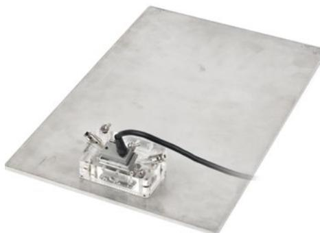
Sonde e zoccoli dritti ad ultrasuoni phased array a orientazione laterale per la ricerca di difetti longitudinali e obliqui.
