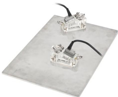
Sonde e zoccoli dritti ad ultrasuoni phased array per la ricerca di difetti longitudinali e obliqui.
