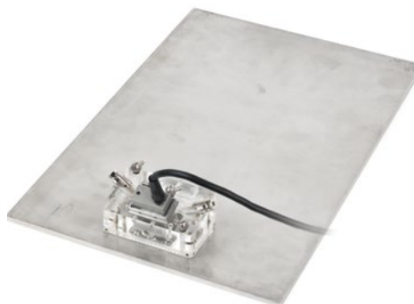
用于识别横向缺陷的横向相控阵探头和楔块
