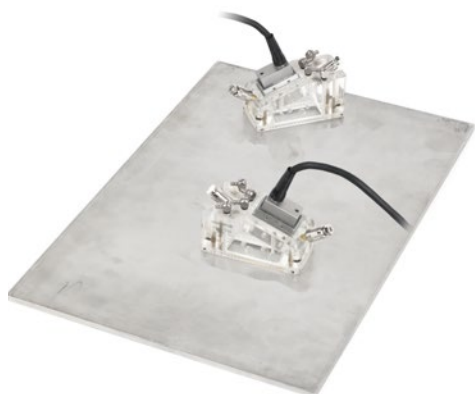
用于识别纵向和斜向缺陷的正常方向的相控阵探头和楔块
