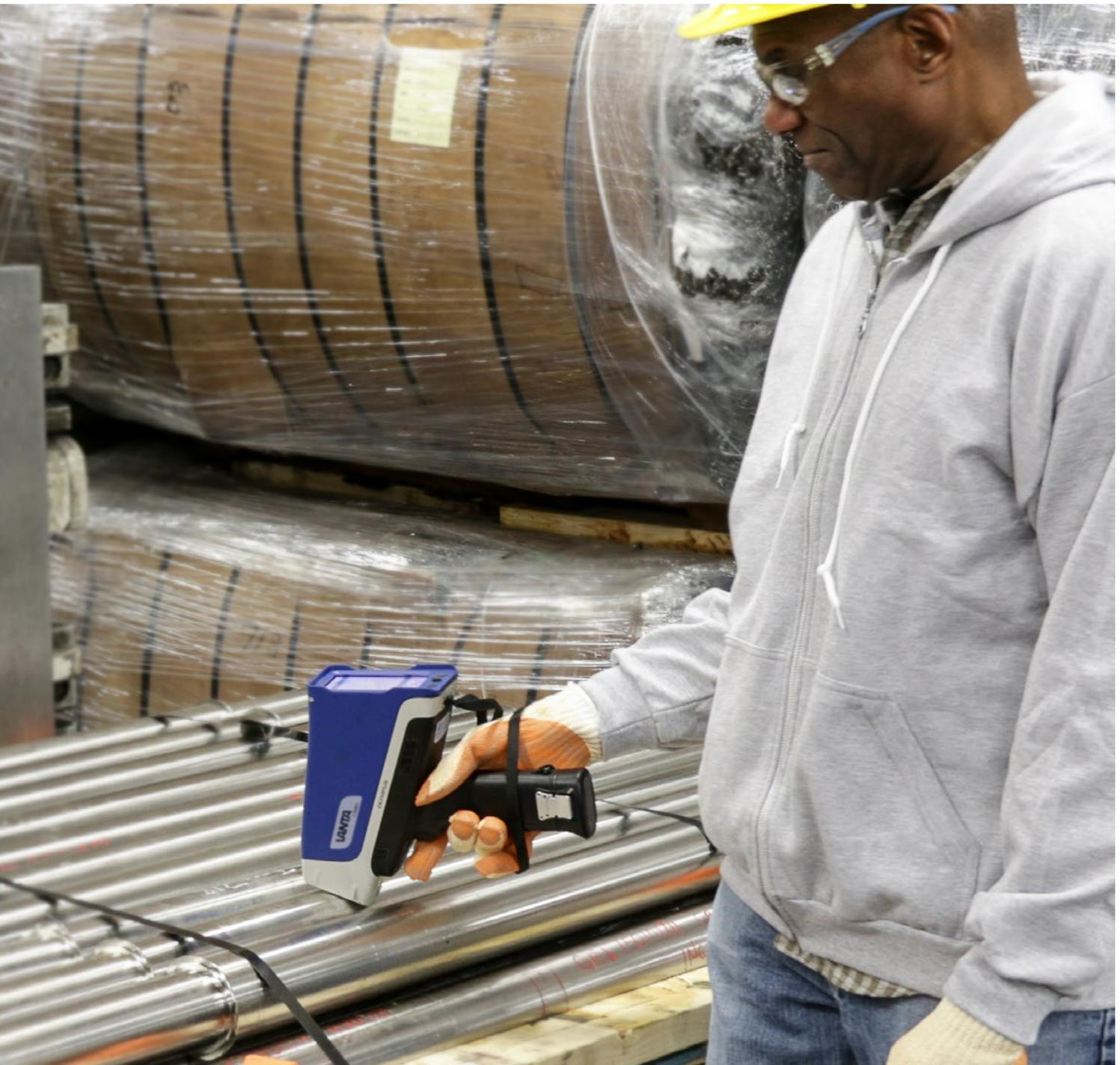
Bei schwankenden Altmetallpreisen ist eine einfache, schnelle und zuverlässige Legierungserkennung für den wirtschaftlichen Erfolg unerlässlich. Vanta Röntgenfluoreszenzanalysatoren für die Altmetallsortierung identifizieren zuverlässig in wenigen Sekunden die meisten Werkstoffe und Einzelmetalle.
