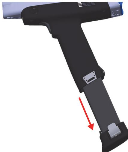
3. Вставьте полностью заряженную батарею в ручку анализатора Vanta, совместив контакты. Форма ручки анализатора позволяет вставить батарею единственным верным образом.
