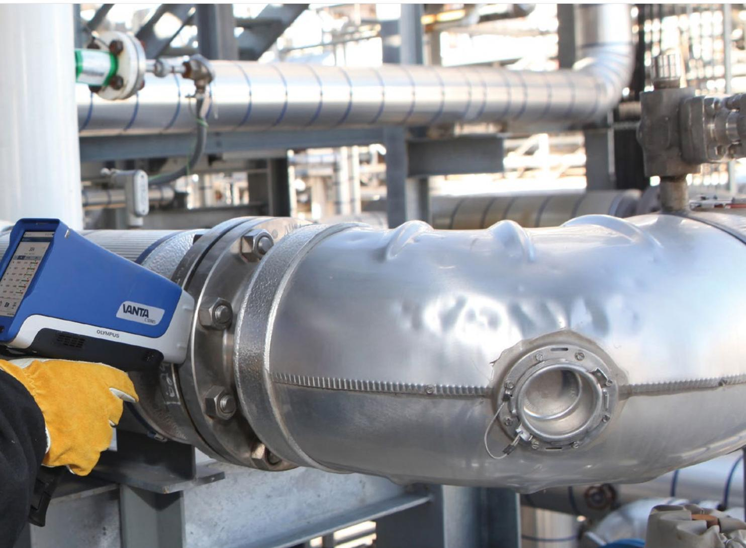
Analizador robusto para identificação positiva de material (PMI). A Olympus redefiniu o significado de robustez dos analisadores portáteis por XRF com a série Vanta™.
