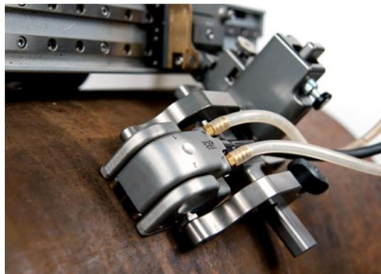
Sonda DLA para la corrosión usada con el escáner MapROVER para inspecciones automatizadas
