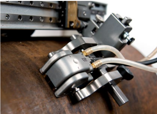
在自动检测中与MapROVER扫查器一起使用的DLA腐蚀探头
