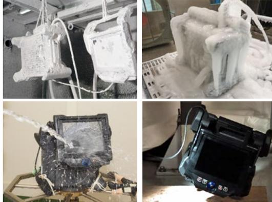
**Fiable et résistant**, l'IPLEX NX est conforme à des normes militaires strictes, dont les normes MIL-STD-810G/461F, et est associé à l'indice IP55 pour la protection contre l'eau et la poussière. La résistance du tube d'insertion à la température de l'air (jusqu'à 100 °C) vous permet de commencer le travail plus rapidement, sans attendre qu'il refroidisse.
