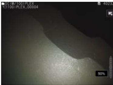
La **fonction d'images fantômes** est utile pour la comparaison des inspections. Les images stockées sur l'IPLEX NX peuvent être superposées sur des images affichées en temps réel afin de permettre la comparaison des conditions passées et actuelles.
