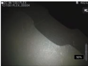
**A função Ghost Image (imagem fantasma)** auxilia na comparação de inspeções. As imagens armazenadas no IPLEX NX podem ser sobrepostas às imagens exibidas em tempo real e comparadas com as condições atuais.
