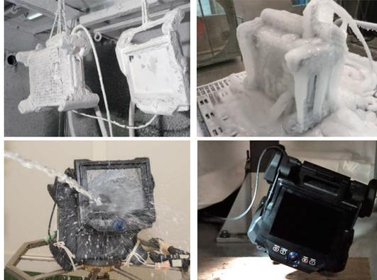
**Resistente e confiável**, o IPLEX NX está em conformidade com as rigorosas normas militares, incluindo MIL-STD-810G/461F e IP55, para proteção contra água e poeira. A resistência à temperatura do ar no tubo de inserção (até 100 °C) indica que você pode trabalhar rapidamente em vez de ter que esperar pelo resfriamento.
