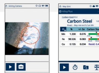
**Контроль качества сварных соединений непосредственно на рабочем месте. Подтверждение марки металла**
