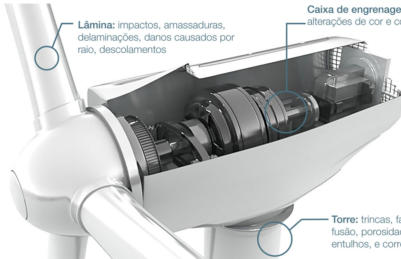
**Lâmina:** impactos, amassaduras, delaminações, danos causados por raio, descolamentos
