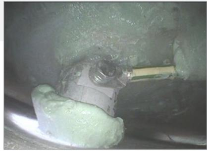
对叶片进行检测，发现雷电造成的损伤，并完成质量控制
