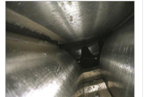
对齿轮的轮齿和轴承进行检测，以发现磨损和锈蚀缺陷，其中包括颜色的变化和点蚀
