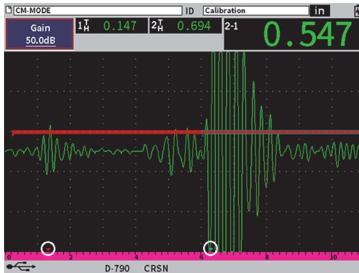
Figura 11-43 Medição eco a eco
