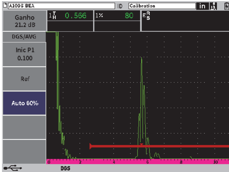
Figura 11-20 Refletor de referência antes da captura
