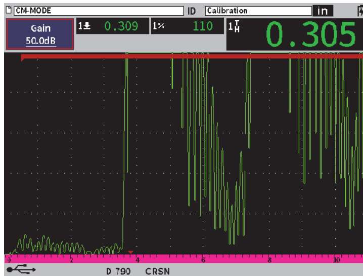
Figura 11-39 Ajustar valor de ganho no modo de precisão
