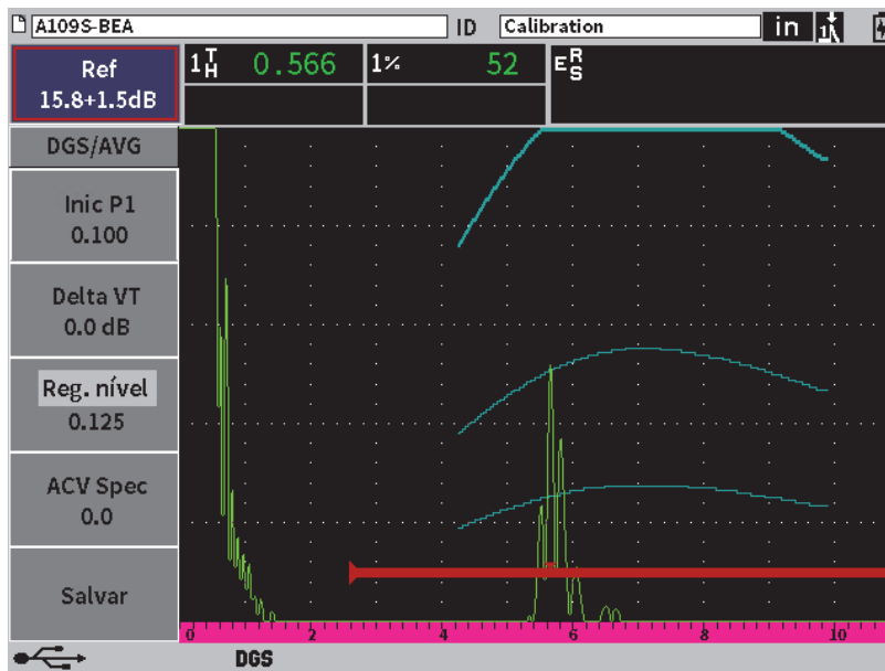
Figura 11-23 DGS ajustado na curva de ganho
