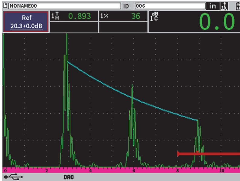
Рис. 11-12 Стандартная DAC с отключенным усилением сканирования
