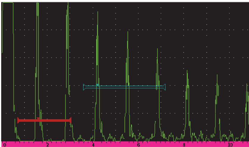
Рис. 2-6 Пример отображения А-скана со стробами
