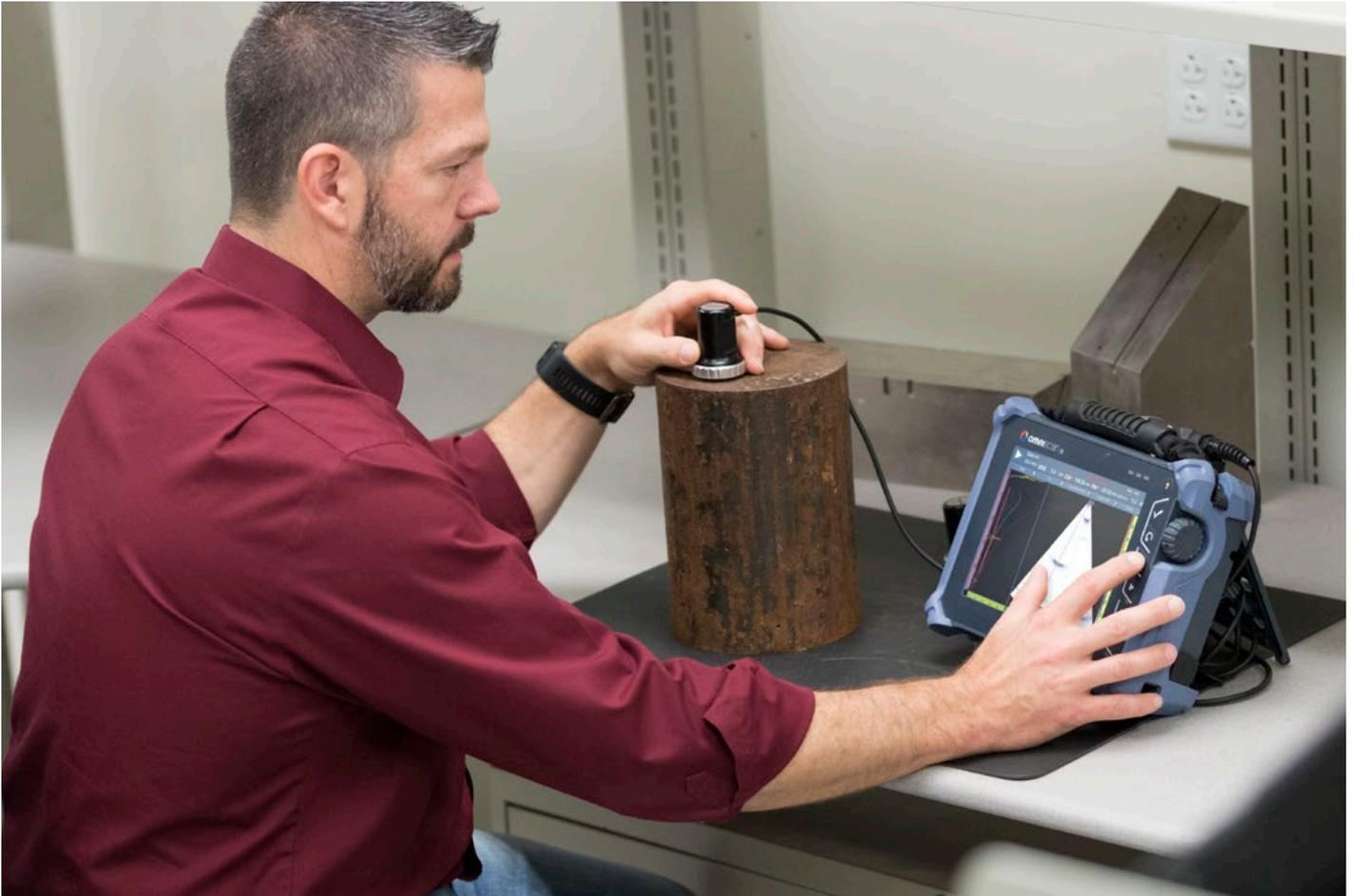
MXU软件的4.4版本包含距离增益定量（DGS）方式，在使用OmniScan MX2或OmniScan SX探伤仪进行检测时，这个DGS方式可以简化检测过程。
