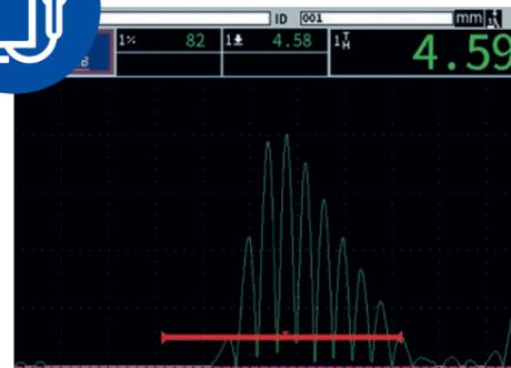
**Control puntual para corrosión**
