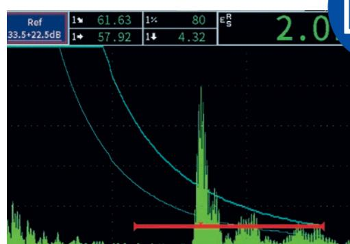
检测管嘴上的焊缝，以探测在役裂纹，即使管嘴在容器的顶部
