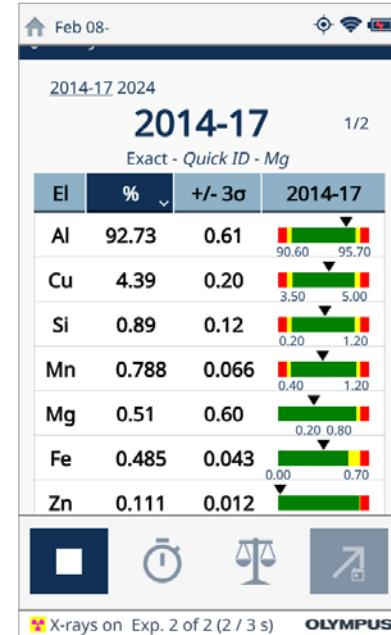
在3秒钟的检测中获得铝材料中含0.51%镁元素的结果
