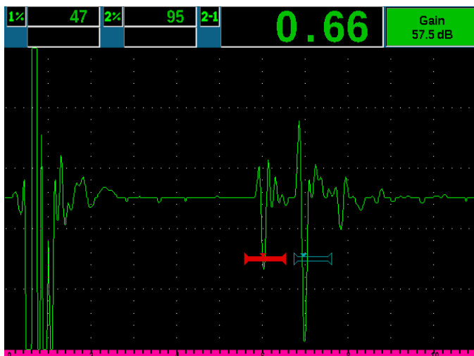
Typische Messung der Oxidschicht im Rohrrinnen mit einem Prüfgerät und dem Vorlaufstreckenmesskopf M2017 mit angezeigtem Vorlaufstreckenecho links auf dem Bildschirm
