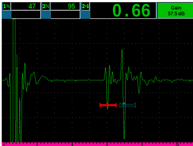
Mesure typique de l'épaisseur de la couche d'oxyde interne avec un appareil de recherche de défauts et une sonde à ligne à retard M2017, montrant l'écho de la ligne à retard à gauche de l'écran
