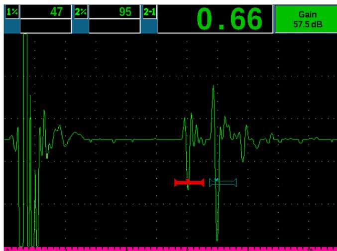
Comune misura della magnetite interna con un rilevatore di difetti e un trasduttore a linea di ritardo M2017; a sinistra della schermata viene illustrata l'eco della linea di ritardo
