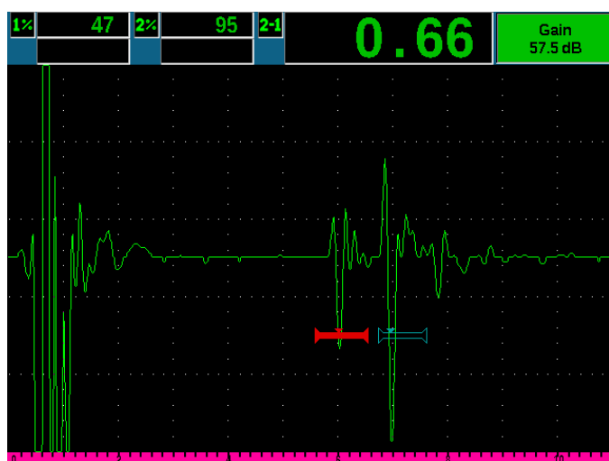
探傷器と M2017 遅延材付き探触子を使用した標準的な内部酸化膜測定。画面の左に表示されているのは遅延材エコー
