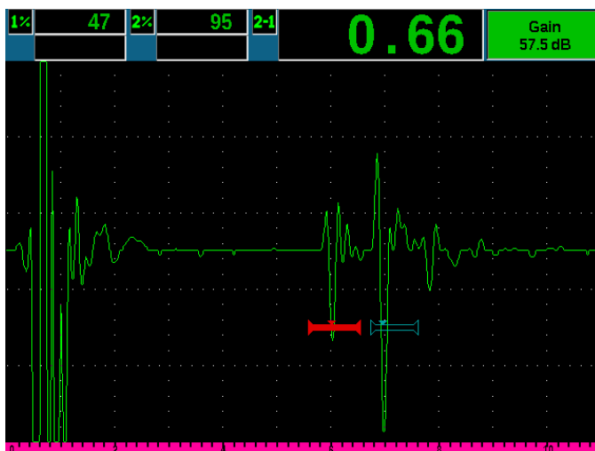
Medição típica de óxido interno com detector de defeitos e o transdutor de linha de atraso M2017; eco da linha de atraso mostrado à esquerda
