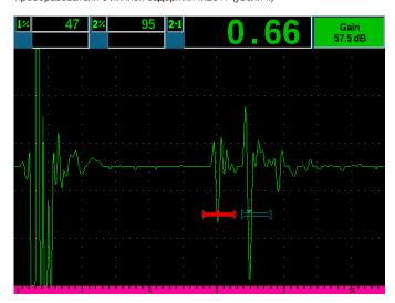
Измерение толщины внутреннего слоя окалины с помощью дефектоскопа и преобразователя с линией задержки М2017 (в левой части экрана виден эхо-сигнал линии задержки
